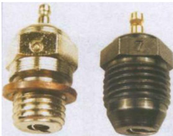
*A gauche, une bougie classique. A droite, une bougie "turbo" caractéristique par sa forme conique et l'absence de joint.*
